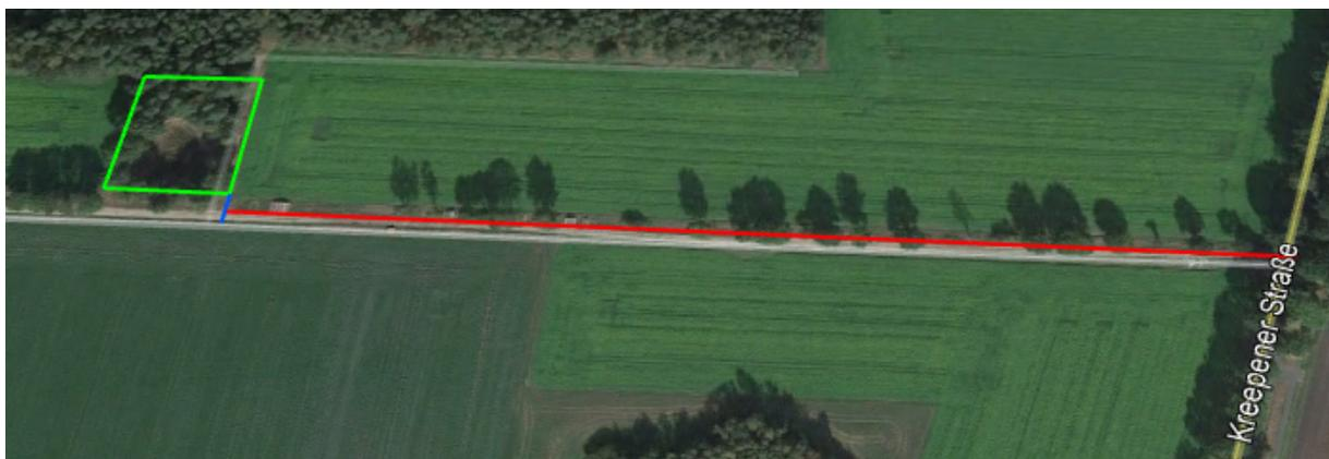
Abbildung 2 Beispiel: Vorgehen zur Lagebestimmung des Süd-Ost-Eckpunktes eines Grundstücks
